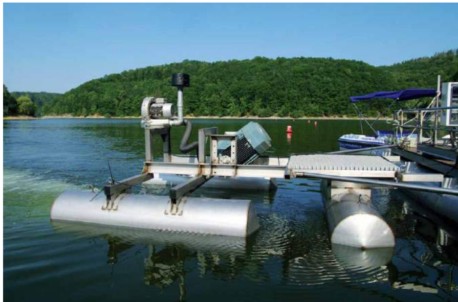
Plovoucí aerační zařízení na hladině Vranovské nádrže. Foto: Ing. Jaroslav Hedbávný
