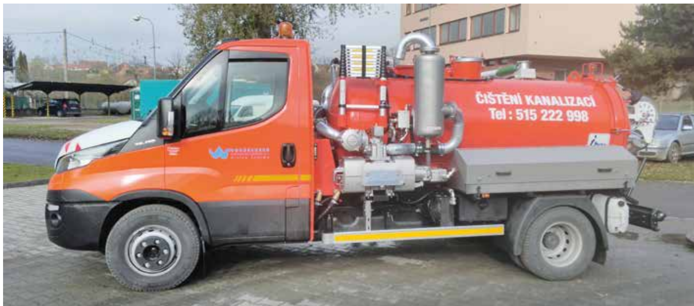
Sacokanalizační vůz „COMBO-3“ divize Znojmo
